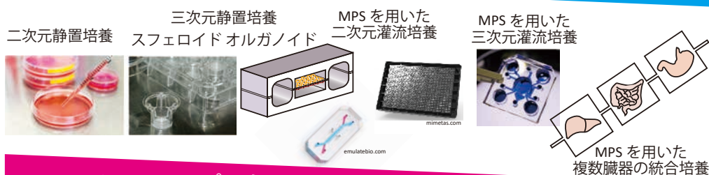
図3 従来の細胞アッセイ法とMPSの位置づけ
